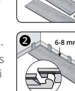
**2.** Asentaminen tulisi aloittaa nurkasta (vasemman puoleesta) ja naaraspontti seinään päin. Pidä reunan etäisyysenä 6 – 8 mm, ISOCORE-lautojen laajenemisen tasaamiseksi lämpötilamuutosten yhteydessä (kuva 2).
