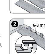
**2.** Pokládku byste měli zahájit v rohu (na levé straně) a s drážkou ke stěně. Dodržujte při tom vzdálenost od okraje 6-8 mm kvůli dilataci palubek ISOCORE při změně teploty (obrázek 2).
