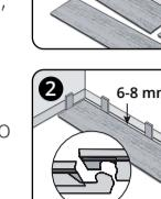
2. S polaganjem začnite v enem od kotov (na levi strani), z utorom proti steni. Upoštevajte potrebno razdaljo 6-8 mm od roba, s katero izravnate raztezanje plošč ISOCORE ob spremembah temperature (slika 2).
