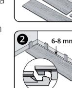
**2.** Installationen bör påbörjas i ett hörn (på vänster sida) och med spåret mot väggen. Beakta ett kantavstånd på 6-8 mm för att jämna ut expansionen av ISOCORE-brädorna vid temperaturbyte (bild 2).
