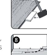
5. Comience la segunda fila con un panel que puede recortar en la forma deseada para el patrón de colocación deseado (los paneles recortados no deben tener una longitud menor de 20 cm, recomendándose un solapamiento de por lo menos 1/3 de la longitud del panel). Véase la figura 5. Mida la longitud deseada del panel y márquela con un lápiz. Corte luego la superficie del panel con un cuchillo universal y doble el panel. Luego, debe cortar el revestimiento integrado en el lado inferior del panel.
