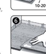
frappez sur le dessus de celle-ci avec le marteau en caoutchouc pour réaliser la jonction. Ce point est particulièrement important pour une jonction de bonne qualité.
