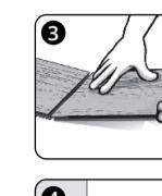
**3.** Při pokládce první řady spojte krátké strany. (Obrázek 3) Pokládejte pera každého nového panelu na krátké straně přesně nad drážkou předchozích panelů, spojte je poklepáním pryžovým kladivem shora. Toto je velmi důležité pro dobré spojení.
