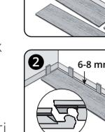
**2.** Döşeme işlemine bir köşede (sol tarafta) ve yiv duvara bakacak şekilde başlanmalıdır. Sıcaklık değişimlerinde ISOCORE döşeme parçalarının genişlemesini dengellemek için, 6-8 mm kenar boşluğu bırakmaya dikkat edin (resim 2).
