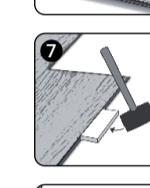
**6.** Sonrasında paneli ilk sıraya (uzun kenar) 10-20 derecelik açı ile sıkı biçimde oturmasını sağlayın. İkinci paneli uzun kenara oturtarak ve yayı ilk panelin kısa kenarındaki oluğa iterek bağlayın. Hafif bir baskı uygulayarak ikinci paneli birinci panelin oluguna dikkatlice çakın.
