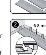
**2.** Lægningen påbegyndes i et hjørne (i venstre side) og med noten ind mod væggen. Etabler en kantafstand på 6 – 8 mm for at kompensere for ISOCORE-plankernes udvidelse ved temperatursvingninger (fig. 2).
