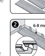
**2.** Paigaldamist tuleb alustada nurgast (vasakult poolt) ja soonega seina suunas. Jälgige, et servast jäab 6-8 mm vahe, mis jätab ruumi ISOCORE põrandate paisumisest põhjustatud ühtlustumisele temperatuuride vaheldumise korral (joonis 2).
