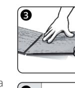
3. Joignez les côtés courts pendant la pose du premier rang. (Fig. 3). Placez avec précision la languette du côté court de chaque nouvelle lame sur la rainure de la lame précédente,
