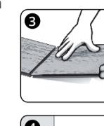
**3.** Förbind de korta sidorna när du installerar den första raden. (Bild 3). Lägg fjädern på varje ny panel på den korta sidan exakt över spåret på föregående paneler, och slå samman dem ovanifrån med gummihammaren. Detta är särskilt viktigt för en bra förbindelse.
