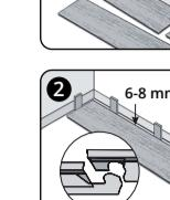
2. La colocación debe comenzar en una esquina (a la izquierda) y con la ranura a la pared. Observe una distancia al borde de 6-8 mm para compensar la extensión de los tablones ISOCORE en caso de un cambio de la temperatura (figura 2).
