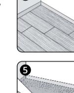
**4.** b!design'yi döşerken, kısa taraftaki birleştirme noktalarının düz çizgi oluşturmasına, yani döşeme hattının tamamen düz olmasına dikkat edin. Son panel için 20 cm'lik toplam döşeme için asgari uzunluk hesaplayın.
