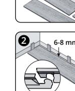
2. A lerakást sarokban kell kezdeni (bal oldalon), a núttal a fal felé. Tartson 6 – 8 mm széltávolságot, hogy az ISOCORE padlók tágulását hőmérsékletváltozásnál kiegylítse (2. ábra).
