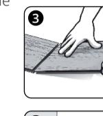
**3.** Verbinden Sie bei der Verlegung der ersten Reihe die kurzen Seiten. (Abbildung 3). Legen Sie die Feder jedes neuen Paneels an der kurzen Seite präzise über die Nut der vorherigen Paneele, klopfen Sie diese von oben mit dem Gummihammer zusammen. Dies ist besonders wichtig für eine gute Verbindung.
