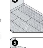
**4.** Achten Sie bei der Verlegung von b!design darauf, dass die Verbindungsstellen der kurzen Seiten eine gerade Linie ergeben, das heisst die Dielenbahn absolut gerade liegt. Halten Sie für das letzte Paneel eine Mindestlänge von 20 cm für die gesamte Verlegung ein.
