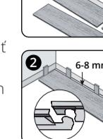
2. Ukladanie by malo začínať v roku (na ľavej strane) s drážkou k stene. Dodržte vzdialenosť od okraja 6 – 8 mm, aby sa vyrównalo rozpínanie podlahových dosiek ISOCORE pri zmene teploty (obrázok 2).
