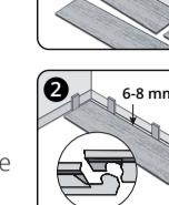
2. Man bør begynne i en hjørne (venstre) og med noten mot veggen. Sørg for en kantavstand på 6-8 mm for å jevne ut ekspansjonen av ISOCORE-plankene ved temperaturændring (figur 2).
