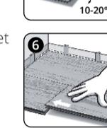
**4.** Under lægningen af b!design skal man sørge for, at samlingsstederne på de korte sider danner en lige linje; dvs. at plankebanen skal ligge fuldstændigt lige. Ved det sidste panel skal der være en minimumslængde på 20 cm for hele lægningen.
