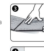
3. En la colocación de la primera fila debe unir los lados cortos. (Figura 3). Coloque la lengüeta de cada panel nuevo en el lado corto en forma exacta encima de la ranura de los paneles anteriores, juntándolos golpeando desde arriba con el martillo de caucho. Esto es especialmente importante con vista a una colocación impecable.
